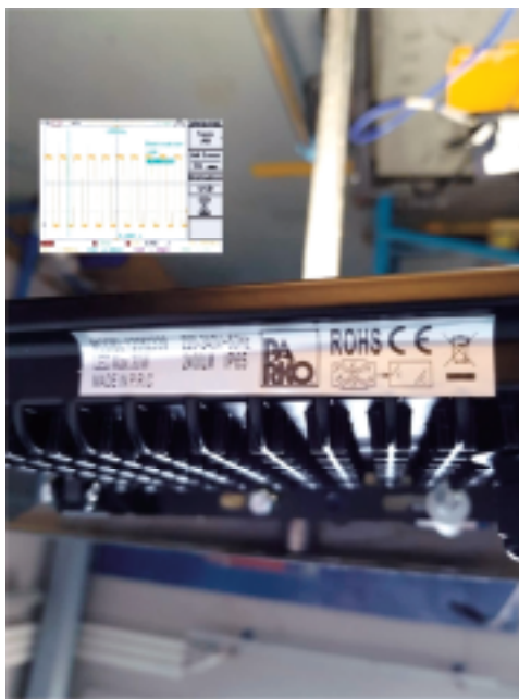
Figura 7: led di cui alla misura 7 con elevata modulazione
